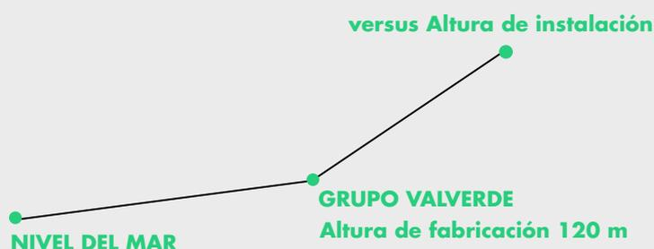
Al instalar una válvula altimétrica, el aire que se encuentra en el interior de la unidad de vidrio aislante empuja la bola de la válvula, saliendo al exterior hasta que la presión se equilibre.
